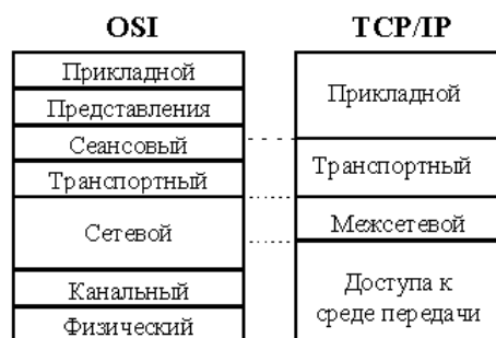
Рис. 4. Соотношение уровней стеков OSI и TCP/IP
