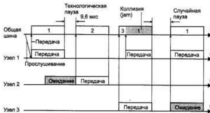
Рис. 3.3. Метод случайного доступа CSMA/CD
